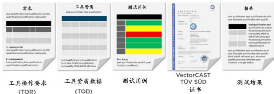
图 6: DO 178B 的测试框架, 机载系统和设备认证的软件考虑。该标准是特定机载系统中的高安全软件的指导方针。
